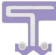
Les bagues M.RR ont deux lèvres actives qui fonctionnent en opposition lorsqu'il y a deux fluides à étancher. Elle contient une armature métallique entièrement enrobée d'un élastomère qui peut être immergé dans l'eau (celui-ci peut être nervuré sur demande).
