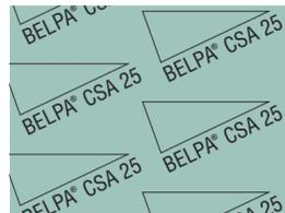
Feuille comprimée sans amiante fabriquée avec des fibres organiques et des fibres minérales, renforçant une formulation d'élastomères. On obtient ainsi une feuille pour joints avec une bonne gamme d'applications de basse à moyenne pression. Sa basse perméabilité au gaz et son prix réduit font de cette feuille le produit sans amiante de choix pour la majorité des usages généraux (eau, air, huiles et graisses divers).
