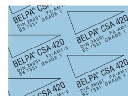
Feuille comprimée sans amiante fabriquée avec un mélange de fibres de haute résistance thermique et mécanique plus une base d'élastomère NBR. Le matériau ainsi obtenu est une feuille pour les services généraux avec une haute résistance mécanique et thermique ainsi qu'une perméabilité basse et un stress résiduel respectant la norme BS7531 qualification grade Y.
