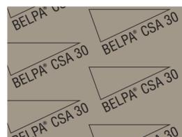
Matériau pour joints à base de fibres minérales, aramidés et de charges inorganiques mélangées à une matrice en caoutchouc. Le matériau ainsi obtenu est une plaque pour joints destinés à un large éventail d'utilisations. Matériau ayant de bonnes propriétés mécaniques et une faible perméabilité. Le matériau pour joints BELPA® CSA-30 est une alternative économique pour la plupart des services communs (eau, air, huiles, dissolvants, etc.).
