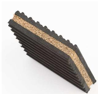
Les tapis anti-vibrations ont été conçus avec des stries inversées au recto et au verso, afin de supporter tout type de charges. Une couche intermédiaire de liège naturel est utilisé pour amortir les vibrations.
