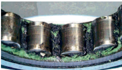
Dégradation du lubrifiant due à des courants de décharge
