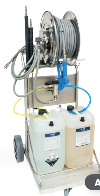
Caddy mousse en inox SK2P-20M-HD3/8-OP avec 20 m de flexible 3/8" sur enrouleur + accessoires avec injecteur à mousse pour 2 produits utilisation avec nettoyeur haute pression (min. 15 l/min) (livré sans produits)
