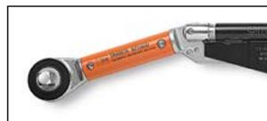
Le mécanisme à cassure avertit l'opérateur que le couple réglé est atteint lorsque le point d'articulation de la clé **se plie d'environ 20°**.
