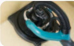
Le côté droit du capot de protection du DSL800 permet de le déplacer le long d'un mur ou d'un plafond.
