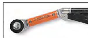
Le mécanisme à cassure avertit l'opérateur que le couple réglé est atteint lorsque le point d'articulation de la clé se plie d'environ 20°.
