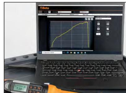
• Transmission de données sans fil, de la clé au logiciel, et inversement, en masse à posteriori ou en temps réel.
